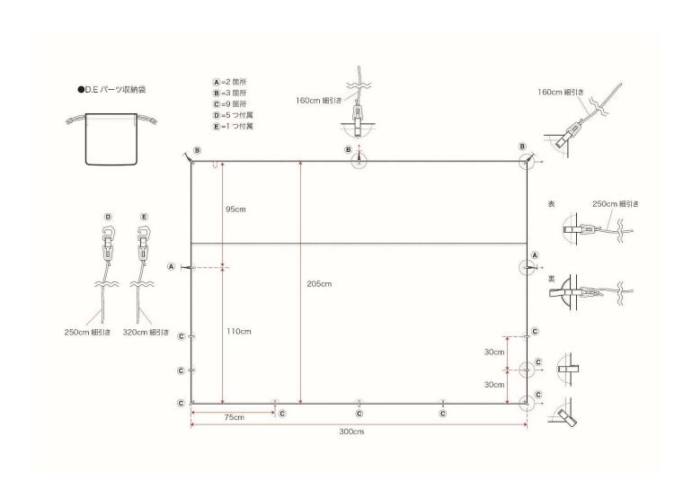
④を中心に®側が背面庇 95cm、©側が前面庇 110cm (生地を最大限有効に使用する設計)
